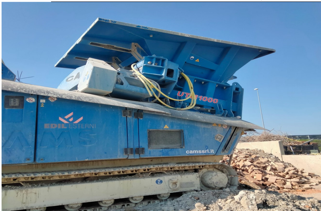
Fig. SIA03_08 Impianto di abbattimento delle polveri montato su trituratore UTM 1000
