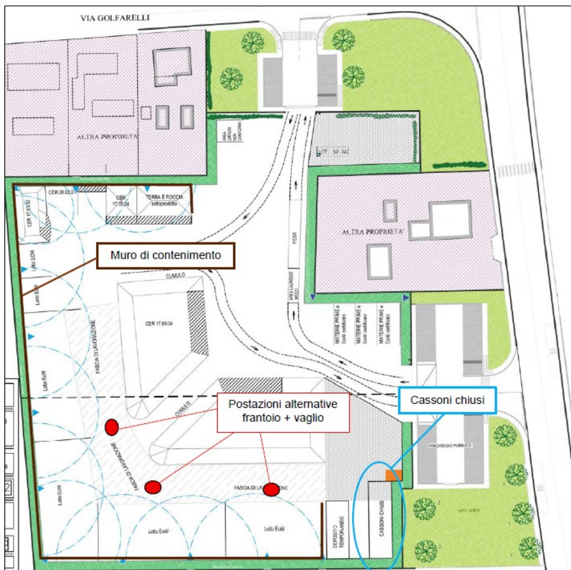
Fig. SIA03_10 Planimetria post operam con evidenziato il muro di contenimento dei rifiuti e materiali inerti
